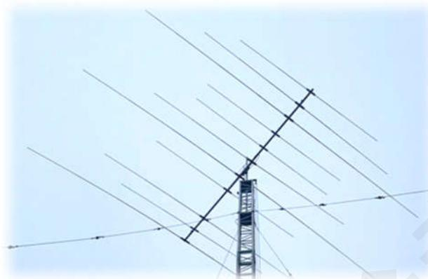
QM311HD 为中等主梁长度的高性能全尺寸八木天线，基于国际流行的成熟设计深度开发而成。采用相位线直接馈电设计，通过单个 UHF 接口便可轻松覆盖 20 米、15 米、10 米共 3 个最常用的业余波段；天线在设计频段内增益平坦；得益于稳定的回波损耗曲线，本产品对潮湿天气不敏感。
