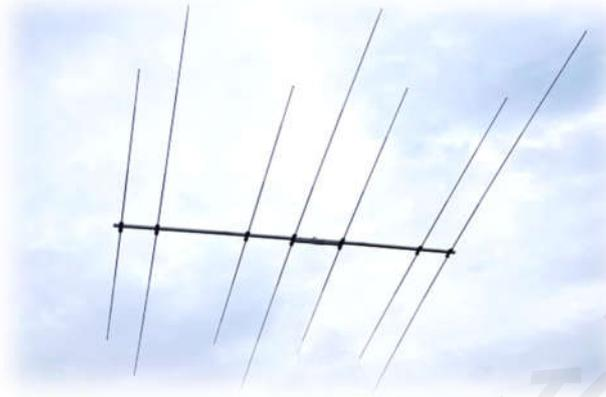
QM207WARC 为中等主梁长度的高性能全尺寸八木天线，基于国际流行的成熟设计深度开发而成。采用相位线直接馈电设计，通过单个 UHF 接口便可轻松覆盖 12 米、17 米共 2 个 WARC 业余波段；天线在设计频段内增益平坦；得益于稳定的回波损耗曲线，本产品对潮湿天气不敏感。
