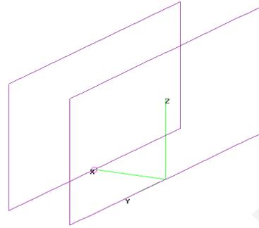
QM06BL2 为 4 单元长方形框阵列天线 (Oblong Beam)，经过长时间的开发与测试，我们完全可以相信，这组精心排列的具有特定长宽比例的长方形振子单元可以在有限的主梁长度上获得更进一步的增益指标——**这是一种不同于传统等间距方框阵列 (Quad Beam) 的设计。**
